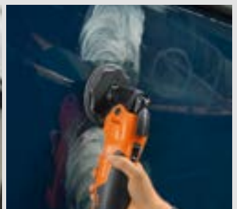
Naarmujen poistaminen ajoneuvojen maalipinnoista huopakiihottustyynyllä ja kiillotusaineella.
